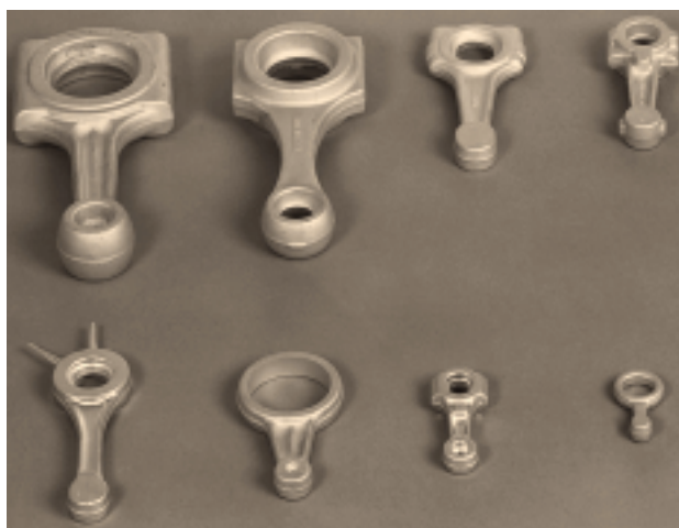
Slika 1: Ojnice iz aluminijevih zlitin, izdelane s kovanjem
