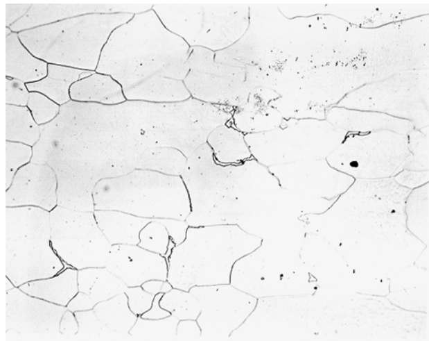
Slika 3: Mikrostruktura HVT z majhnim deležem C, N (povečava 500-krat)
