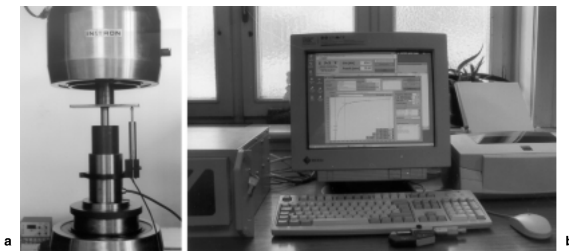
Slika 2: a) Instrumentirano orodje za analizo vedenja prahov med hladnim enoosnim stiskanjem prahu s senzorji tlaka in pomika ter b) povezava z računalnikom, ki avtomatsko sproti zapisuje, obdeluje in ugotavlja (izpisuje) izmerjene vrednosti
