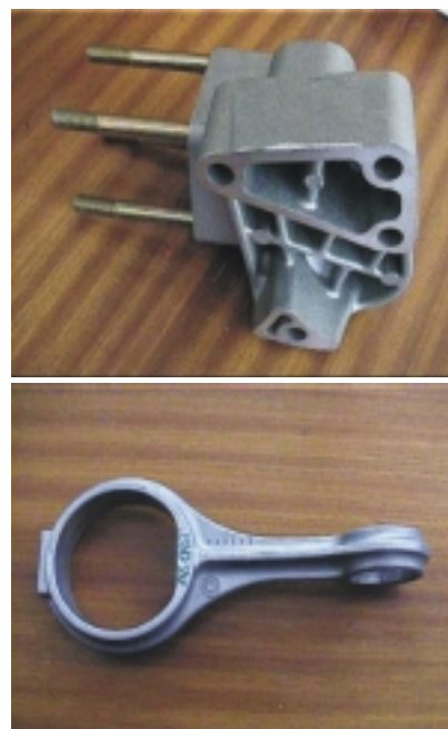
Sliki 4 in 5: Komponenta 1 (toplotno obdelana) in komponenta 2 (ulita), obe iz zlitine A 357
