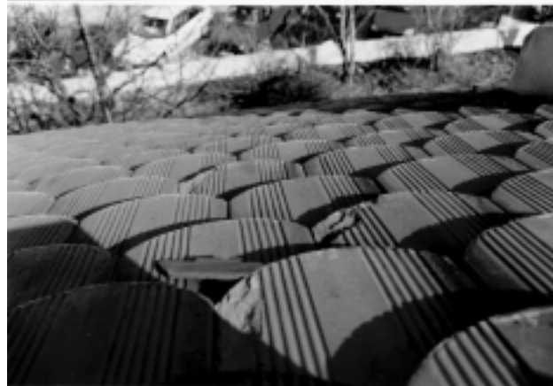
Slika 4: Luščenje glazure loščenih keramičnih ploščic po preskusu na zmrzovanje
