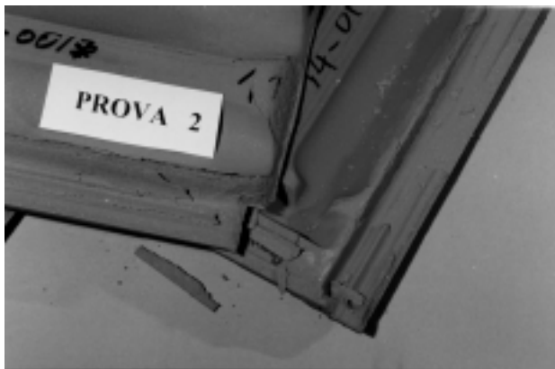
Slika 1: Luščenje tanke plasti površine črepinje po preskusu zmrzovanja
