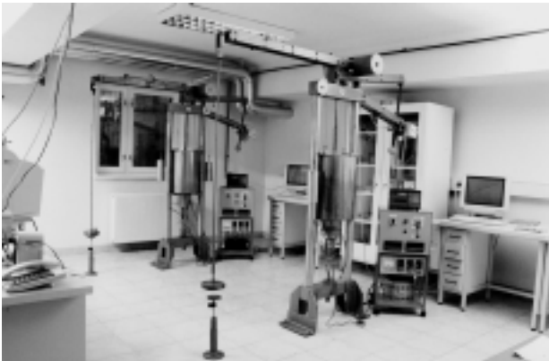
Računalniško krmiljena naprava za meritve počasne deformacije pri visoki temperaturi Computer controlled equipment for creep measurements
