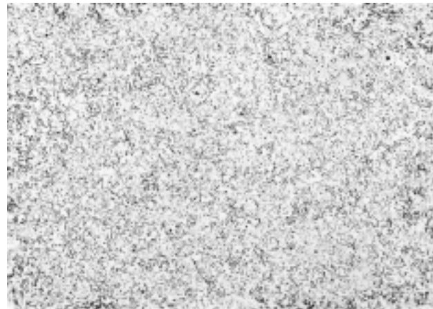
Slika 2: Mikrostruktura jekla Niomol 490 K. Povečava 100-kratna Figure 2: Microstructure of the steel Niomol 490K
