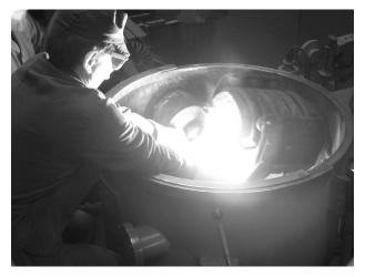
**Figure 5:** Casting of sample for chemical analysis **Slika 5:** Ulivanje vzorca za kemijsko analizo
