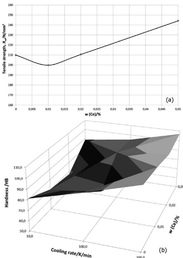
**Figure 10:** Tensile strength (a) and hardness (b) of AlSi9Cu3 alloy for various Ce additions**Slika 10:** Natazna trdnost (a) ter trdota (b) zlitine AlSi9Cu3 pri različnih koncentracijah Ce
