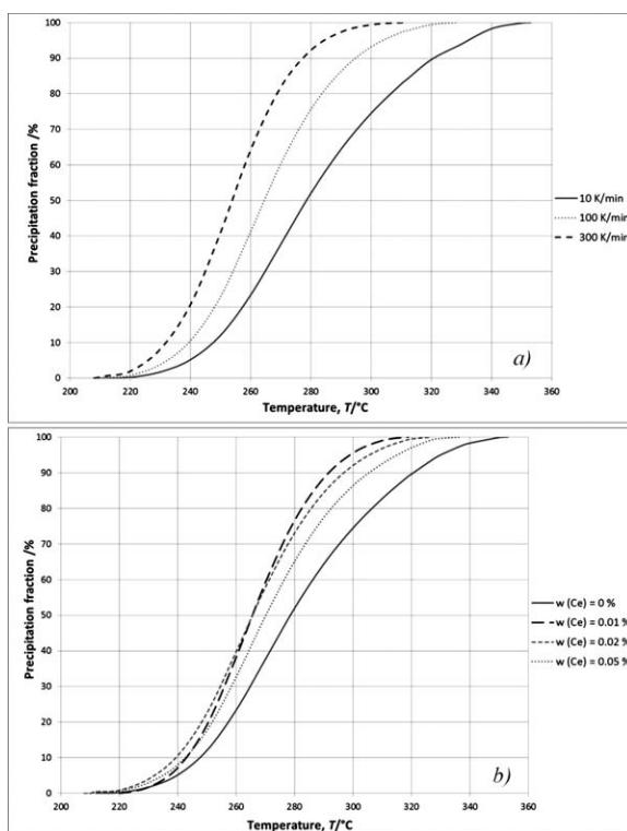
**Figure 6:** Delež izločkov Al<sub>2</sub>Cu v odvisnosti od temperature v AlSi9Cu3 zlitini po različnih hitrostih ohlajanja (a) ter pri različnih koncentracijah Ce (b)
