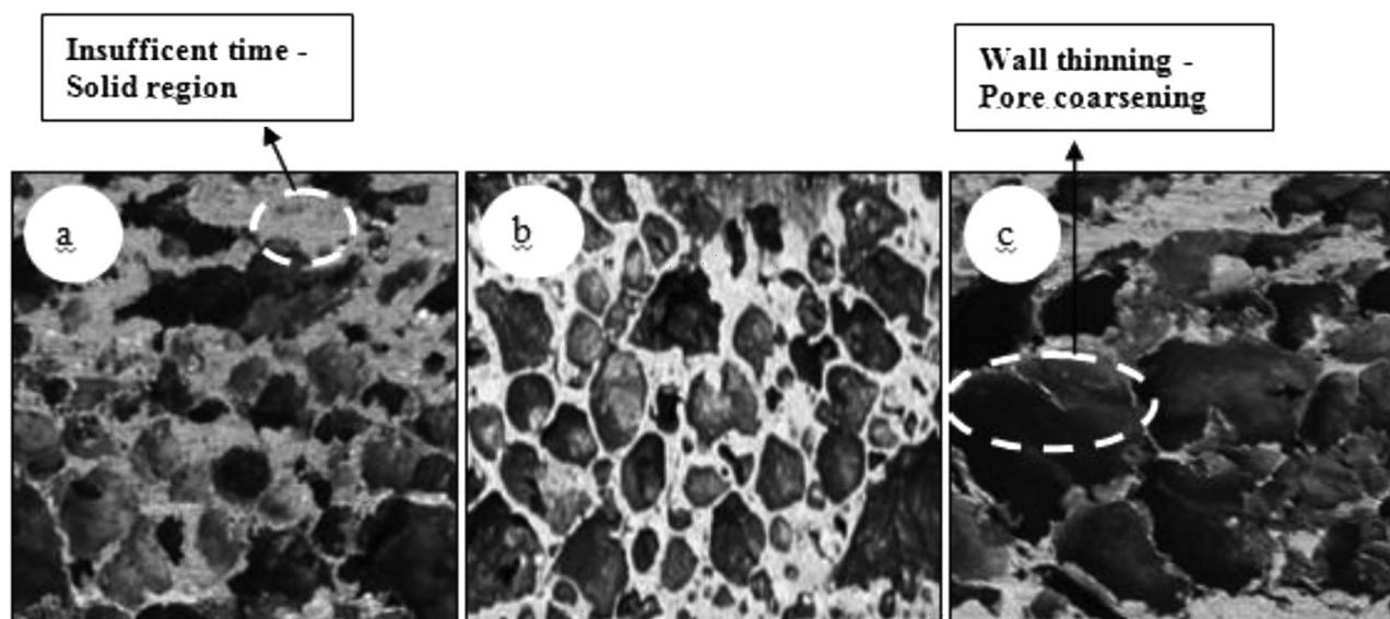
**Figure 4:** Effect of foaming duration on pore morphology: a) 8 min, b) 10 min, c) 16 min
