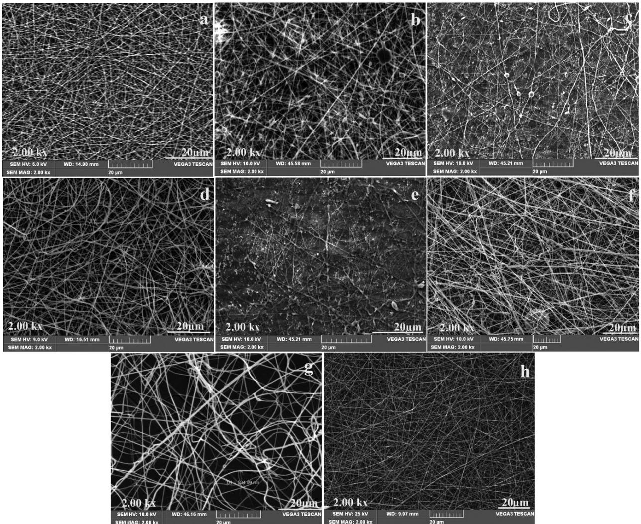
Figure 6: SEM images of uncalcinated fibres: a) U1, b) U2, c) U3, d) U4, e) U5, f) U6, g) U7, h) U8
